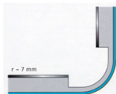
Fresatura a sezione rettangolare per piegatura fino a 150° in funzione dello spessore del pannello.
